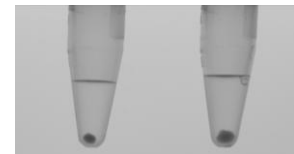
Abb. 1: empfohlene Pelletgrößen Links: max. bakterielle Pelletgröße Rechts: max. Pelletgröße für Probe, die Hefe enthält
